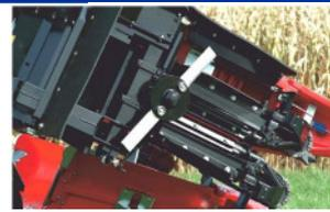
Standard: Unterbauhäcksler unterschiedlicher Bauarten an Maispflückern
