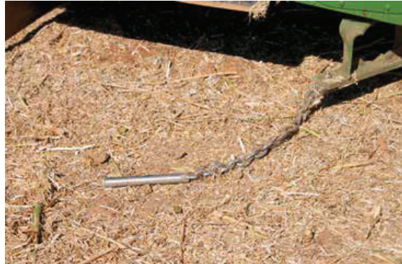
Arbeitswerkzeug des auf einer Kreiselege basierenden Kreisel-schlägers der Firma z-ex
